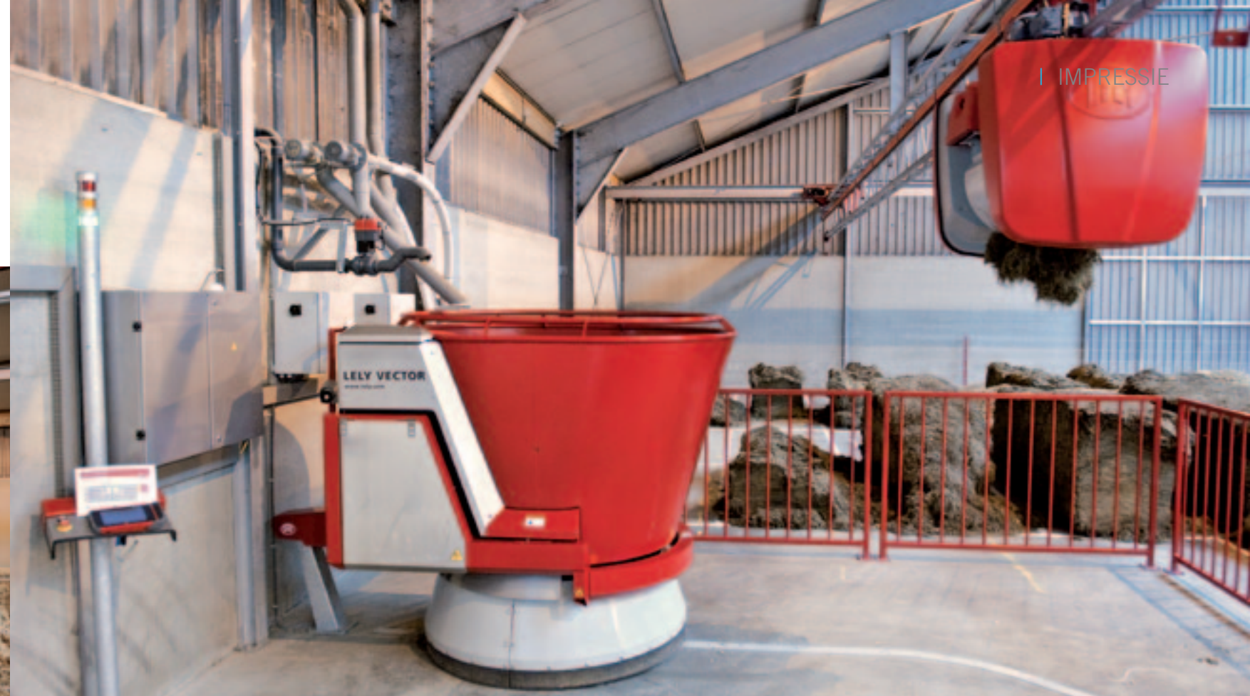
Tijdens het mengen is de robot aangesloten op het elektriciteitsnet. De wagen mengt op 380 volt, terwijl de gripper is aangesloten op 220 volt. Het bedrijf moet op 25 ampère gezekeerd zijn. Een hek en schrikdraad zorgen ervoor dat de voerkeuken niet toegankelijk is voor mensen en dieren.
