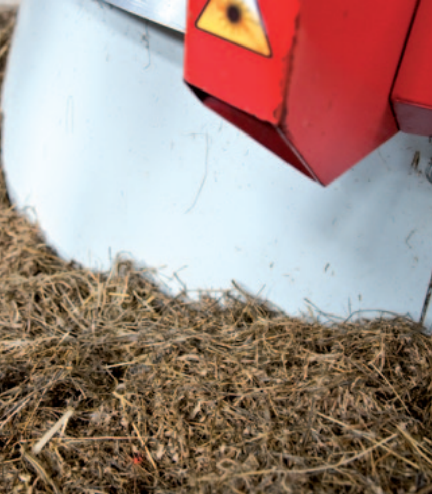
Een voerhoogtesensor bepaalt met infrarood hoeveel voer er voor het voerhek ligt. Is dat minder dan een ingestelde waarde, dan haalt de robot een nieuw mengsel.
