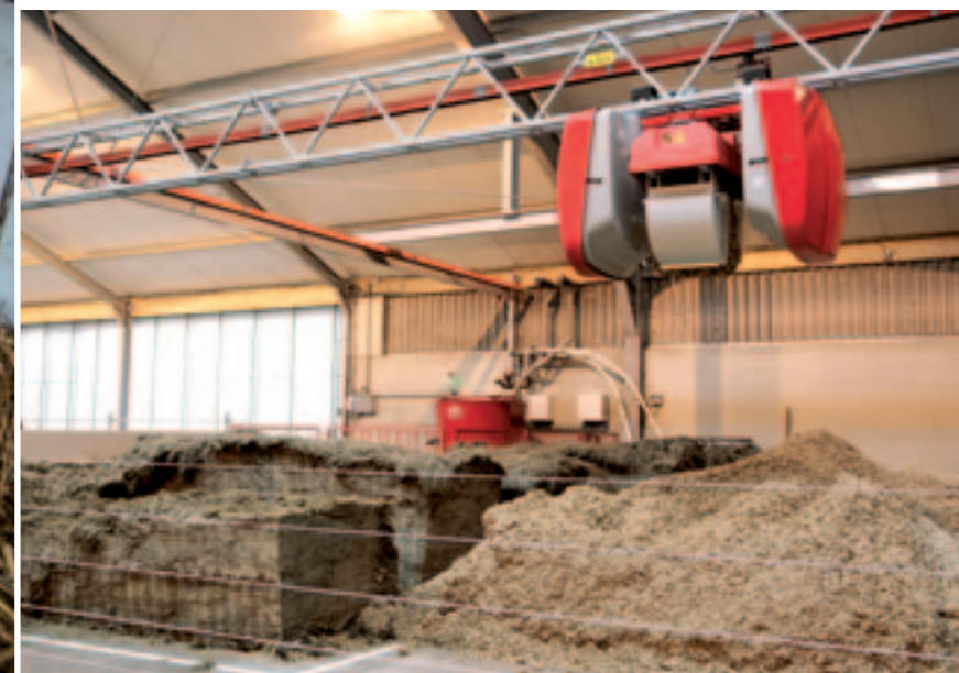
Een gripper brengt het voer naar de mengkuip. Steeds wordt het hoogste deel van het blok of de hoop voer het eerst ‘afgevreten’.
