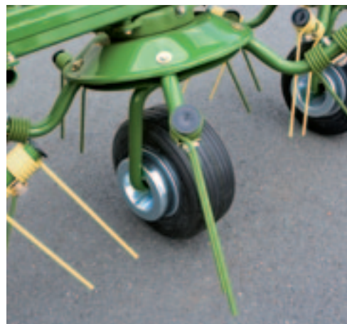
Elke rotor van de Krone-schudder is voorzien van een wiel met een brede band.
