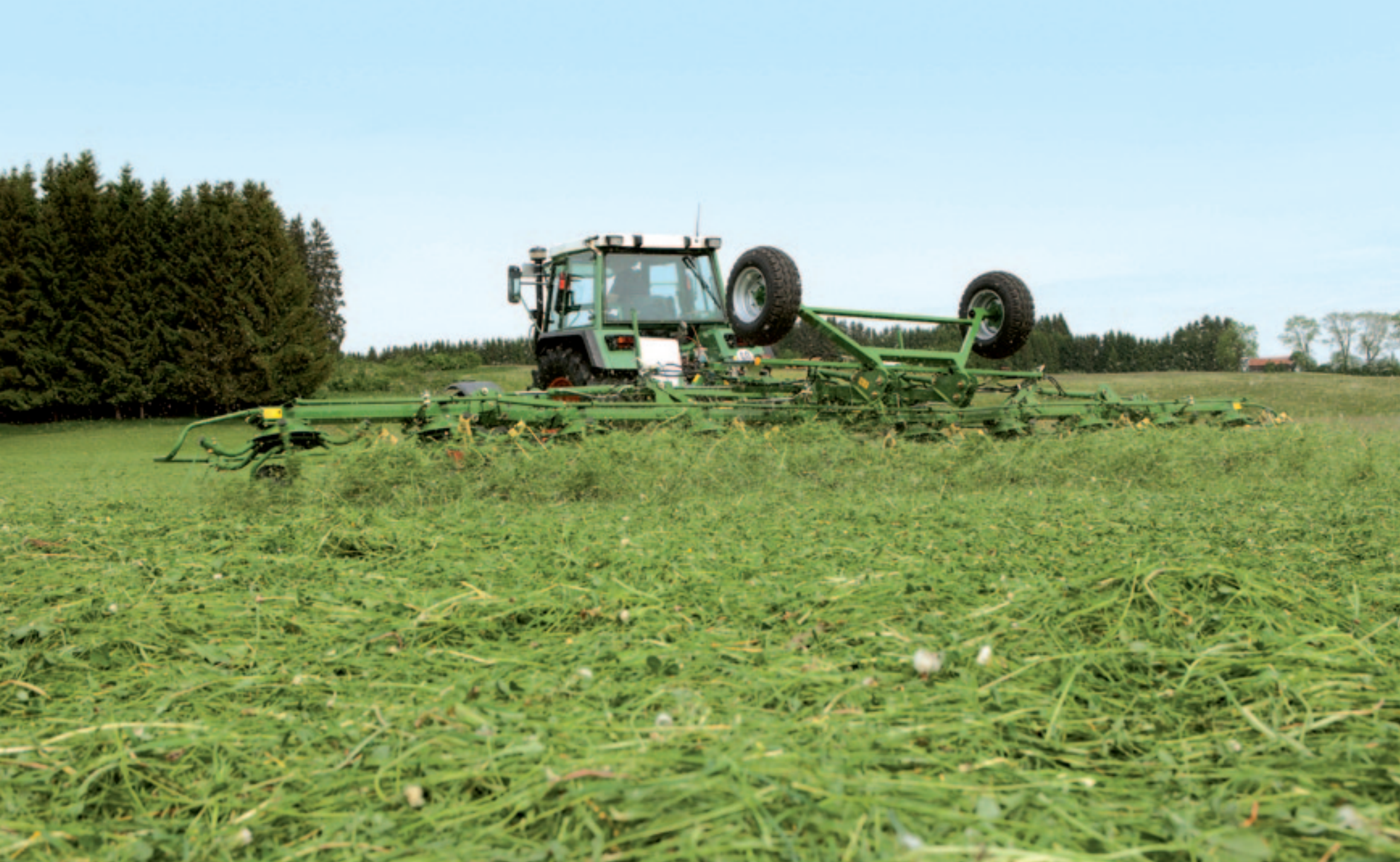
Dubbele tanden van verschillende lengte zorgen voor optimale gewasopname en minimale beschadiging van de zode.
