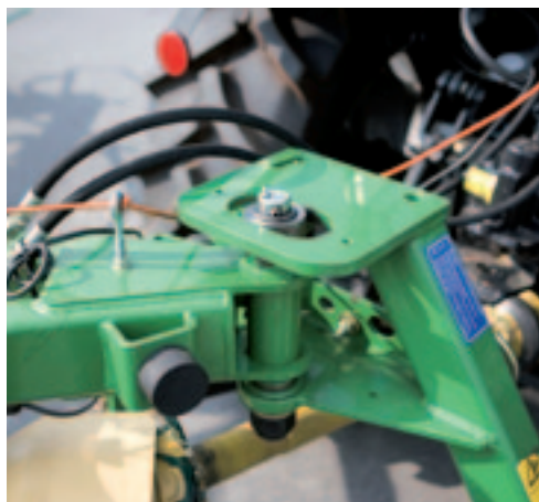
De tweepuntsbok is pendelend opgehangen zodat bodemoneffenheden goed kunnen worden opgevangen.
