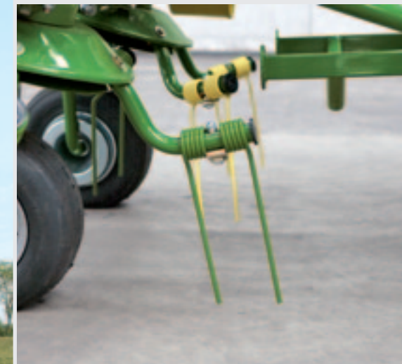
Dubbele tanden van verschillende lengte zorgen voor optimale gewasopname en minimale beschadiging van de zode.
