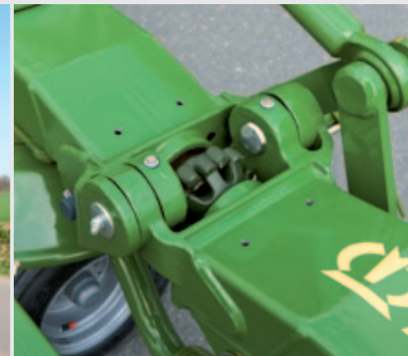
De onderhoudsvrije vingervormige overbrenging maakt het mogelijk om de buitenste schudelementen 180 graden naar binnen te klappen.
