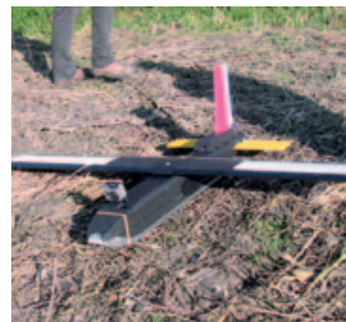
▲ Een UAV is een klein onbemand vliegtuigje dat met behulp van gps percelen in kaart kan brengen. Hij is uit te rusten met verschillende soorten camera's.
