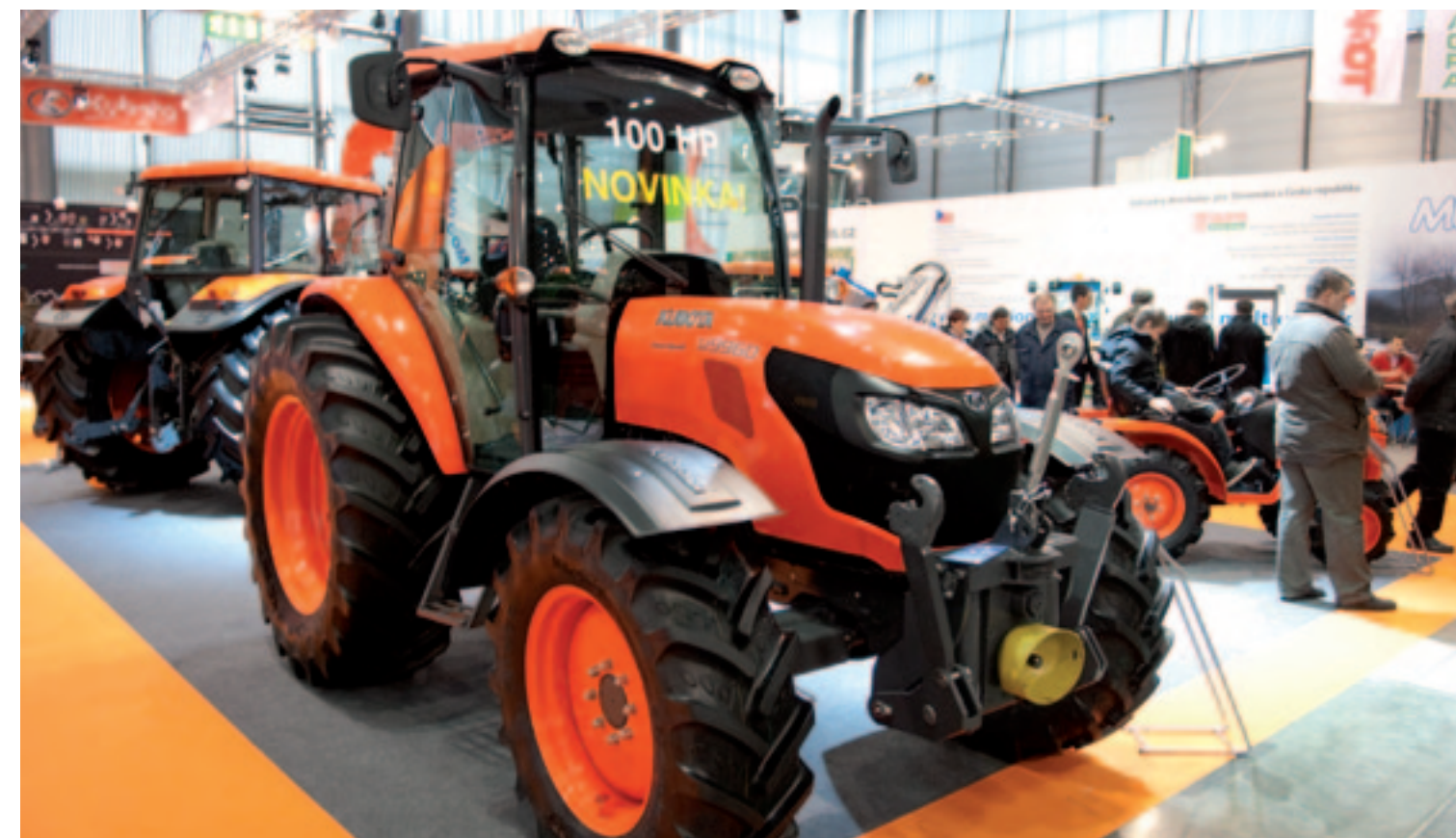
▲ De Japanse fabrikant Kubota stelde de nieuwe M9960 al in de Verenigde Staten voor. Tijdens de TechAgro was hij voor het eerst in Europa. De trekker is een doorontwikkeling van de M9540 en is voorzien van een Kubota motor met een vermogen van 74 kW (100 pk). Deze common-rail krachtbron voldoet aan de Stage 3b-eisen. Daarvoor is hij voorzien van uitlaatgasrecirculatie en een partikelfilter. Het bovenste deel van de voorruit is gebogen voor meer zicht op een voorlader.
