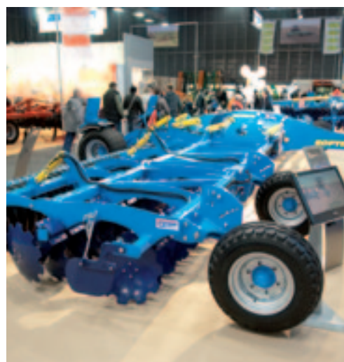
▲ Farmet is een Tsjechische fabrikant van grondbewerkingsmachines. Tijdens de beurs introduceerde het bedrijf vooral bredere versies van reeds bestaande werktuigen. Zo ook deze Softer 11. De stoppelbewerker heeft een werkbreedte van 11 meter en twee rijen schijven met een diameter van 51 cm. Een laatste rol met rubber ringen drukt de grond weer aan. Om de 8.300 kg zware machine met een snelheid van 15 km/h voort te bewegen is een trekker van ten minste 245 kW (330 pk) nodig.
