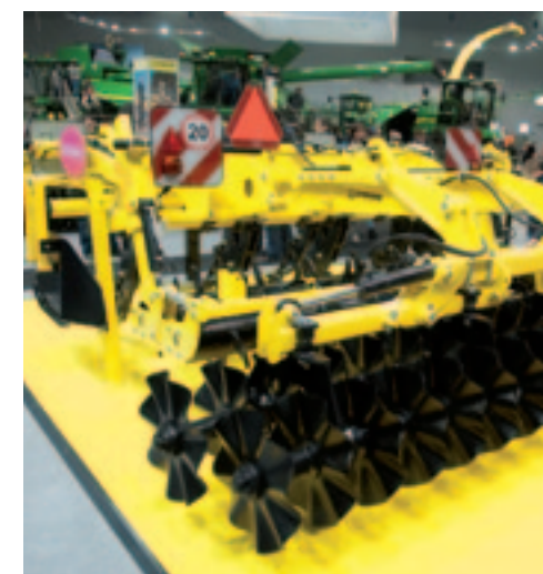
▲ Een gigantische stand voor het Tsjechische merk Strom. Ook tijdens Agritechnica viel het merk, dat er prat op gaat heel degelijke machines te bouwen, al op. De fabrikant van knalgele grondbewerkingsmachines bouwt onder meer deze Terraland TN Profi-cultivator. Het bedrijf heeft de machine zelf al vier jaar in het programma, de dubbele rij schijven is nieuw. De werkdiepte bedraagt 15 tot 65 cm en de werkbreedte, afhankelijk van het model, 3 of 4 meter. Je hebt wel een trekker van minstens 300 pk nodig. De versie van 3 meter kost 21.500 euro.
