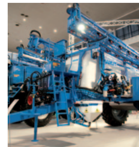
▲ Het Tsjechische Agrio maakt getrokken en zelfrijdende spuitmachines. De fabrikant bouwt de frames van de zelfrijder naar het voorbeeld van Bräutigam in de eigen fabriek. Deze Mamut 8000 is het topmodel uit de serie getrokken veldspuiten. De machine heeft een tankinhoud van 8.000 liter en de spuitboom is 30 meter breed. Al is ook 36 meter leverbaar. Het bedrijf gebruikt 'dure' onderdelen waaronder de BPW as en Mueller-elektronica. De machine is voorzien van pneumatische afsluiters, hoogtesensoren en xenonverlichting. Hij kost 60.000 euro.
