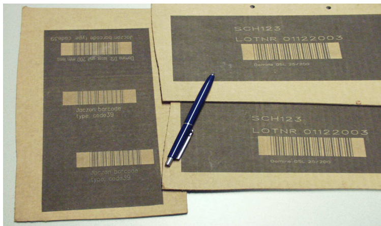
Afbeelding 5.1, Barcode printproeven met een Domino Laserprinter.
