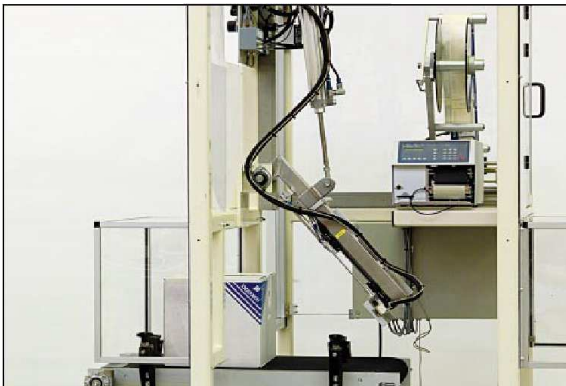
Afbeelding 5.3, Foto van een Bopack etiketteer applicator in werking.
