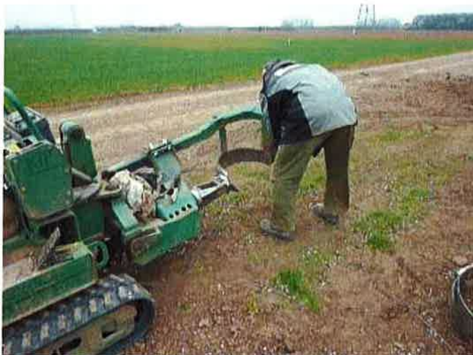
Figuur 5. Wisseling van het mes voor verschillende kluitmaten.
