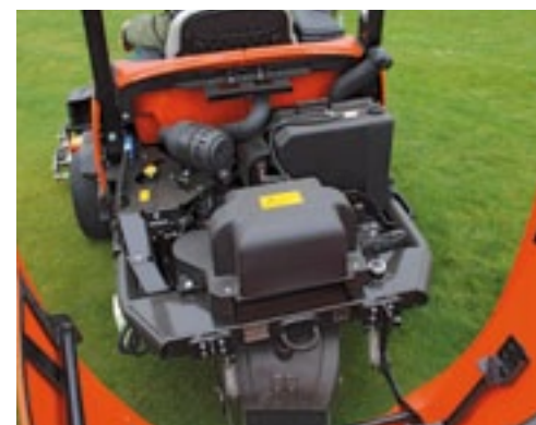
De motorkap klapt 90 graden weg. De blauwe stekker links is de stroomaanvoer.
