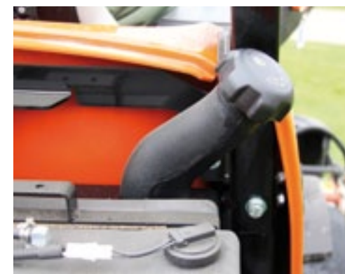
De vulpijp van de brandstoftank is te klein, vindt Ed Voogt. De diesel gutst er bij het vullen uit.
