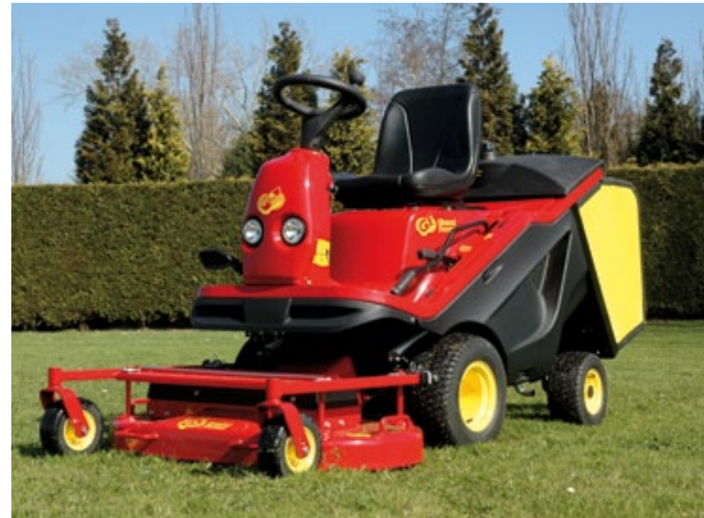
De Gianni Ferrari GTR 160/200 is een machine met frontmaaier en middenafvoer gericht op het middensegment. De basis van de maaier is gelijk aan die van de GTM met maaidek tussen de wielen.
