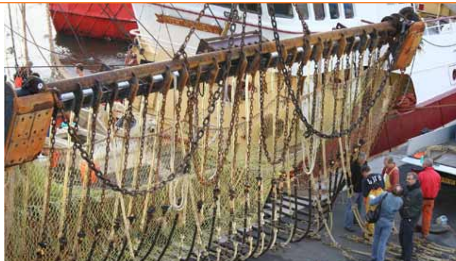
Een pulskor jaagt vissen met elektrische schokjes uit de bodem.
