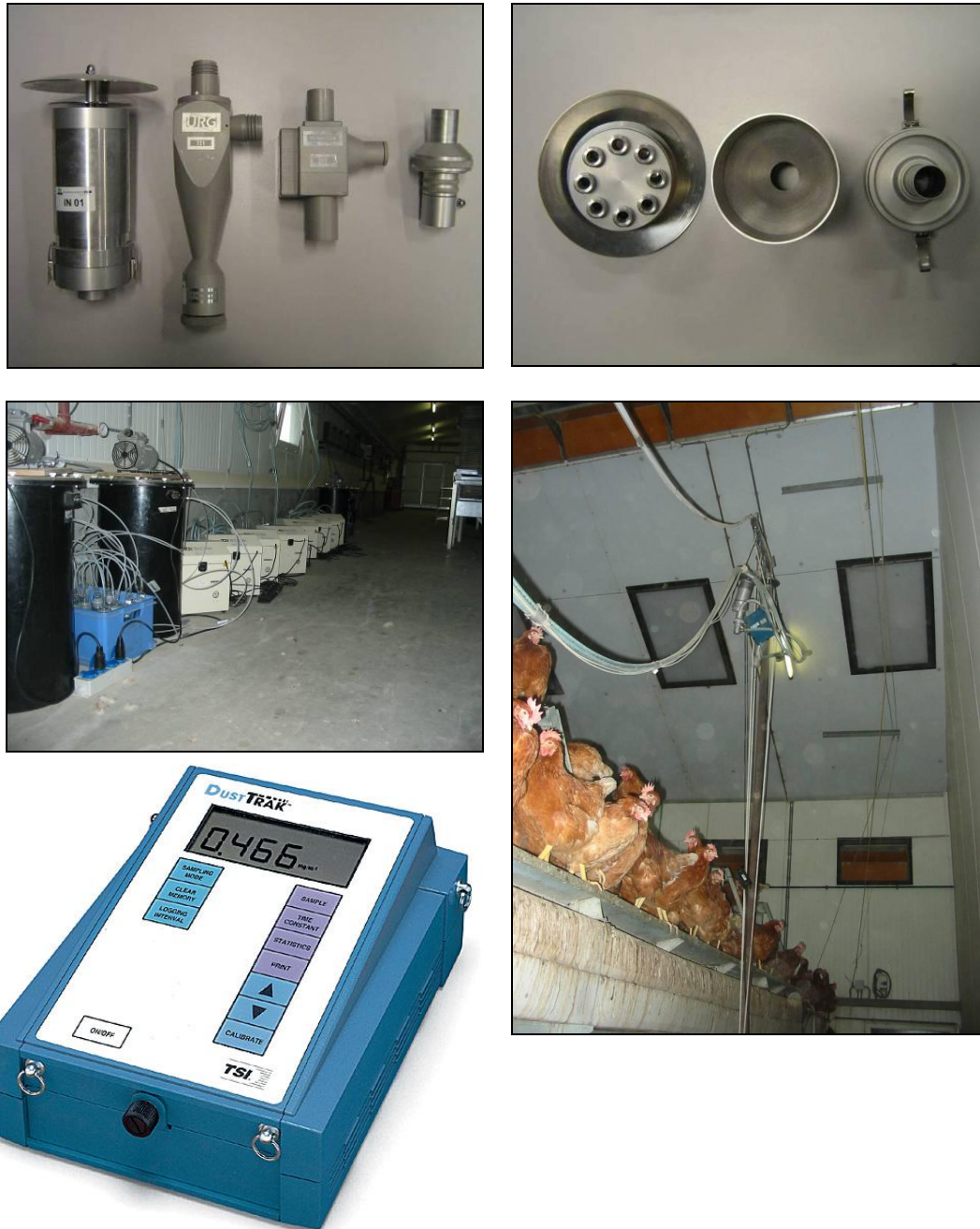
Figuur 4 Monsterapparatuur voor PM10 en PM2.5. Linksonder (van links naar rechts): de inlaat, PM10 en PM2.5 cyclonen en filterhouder. Rechtsboven: de constructie van de inlaat van de cycloon. Linksmidden: meetopstelling; v.l.n.r.: monsternamevat, wasflessen voor ammoniak, geurvast en acht 'constant flow' monsternamepompen. Linksonder: DustTrak voor het meten van persoonlijke belasting aan PM10. Rechtsonder: positie van monstername in de stal, ca. 1,5 m onder de nok (meetgalg met ophangpunten voor meetkoppen)
