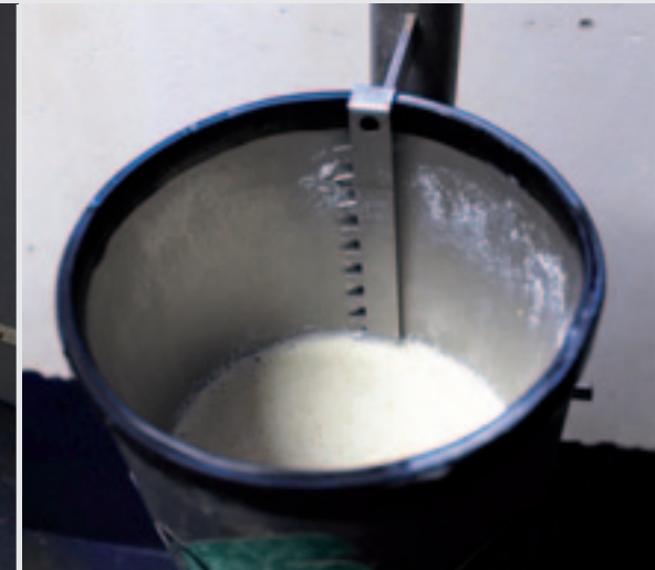
De schaalverdeling in het afvulstation. Door de ruimte tussen wand en schaalverdeling moeilijker schoon te maken.
