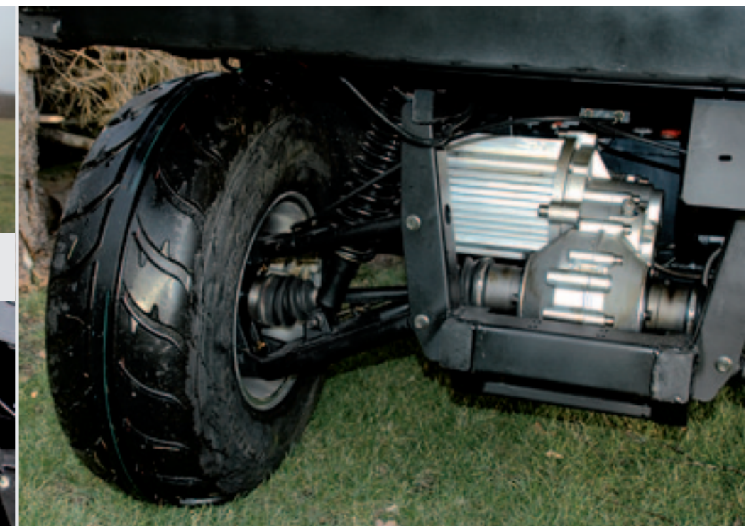
De elektromotor zit op het differentieel van de achteras. Met deze combinatie komt de FM-50 probleemloos de bocht om. Een sper is volgens Frisian Motors voor normale omstandigheden niet nodig.
