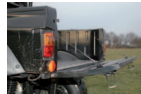
De laadbak is 110 cm breed en 90 cm lang. Een lengte van 130 cm is een optie.
