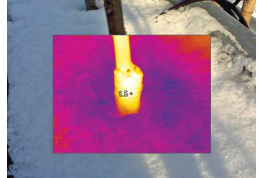
Foto 3: Aan de zuidzijde ligt de temperatuur in de zon boven het vriespunt.
