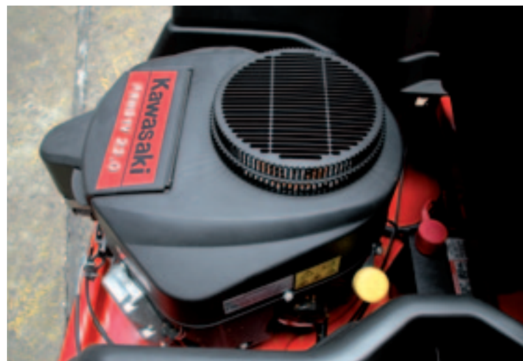
De 22 pk Kawasaki V-Twin benzinemotor op de semi-professionele Massey Ferguson 50-22 ZT. De professionele machines hebben meestal een diesel.
