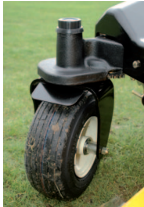
De zwenkwiepen op de Z-Force zijn nu stuurwielen en helpen op taluds en hellingen om de maaier op een vaste koers te houden.
