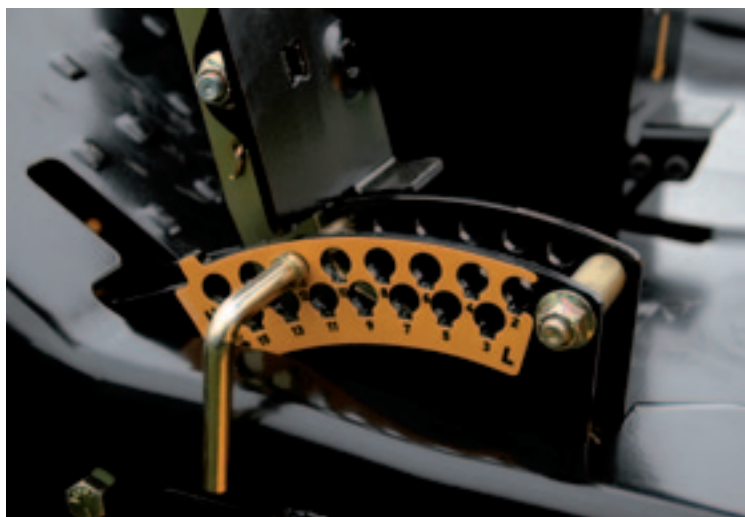
Maaierregeling met pedaalvergrendeling op een ztr van Cub Cadet. Naarmate de stappen kleiner zijn wordt de tevredenheid meestal groter.
