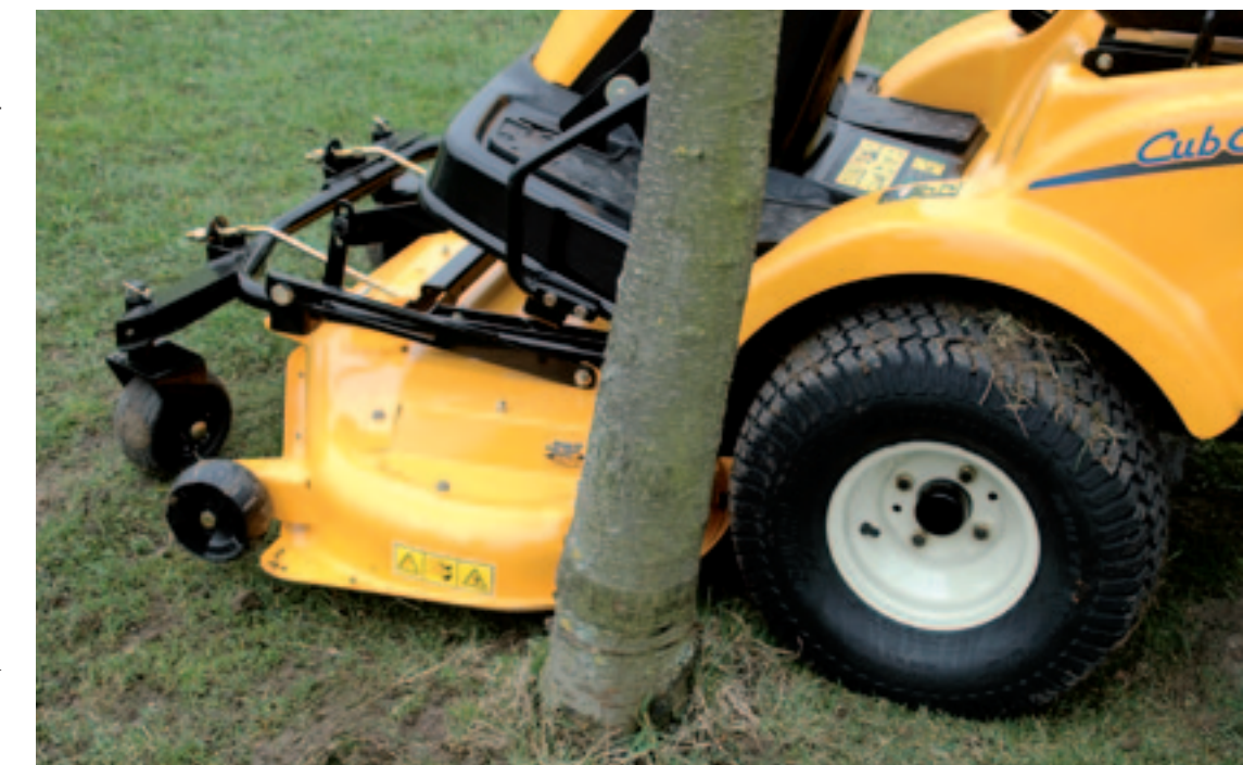
Het 'ronden' van een boom of van een ander obstakel is met een zeroturnmaaier niet per definitie makkelijker dan met een gewone maaier. Ook bij deze ztr (zero turn radius) wil het achterwiel binnendoor.
