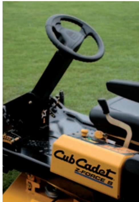
Het stuurwiel op deze Z-Force van Cub Cadet maakt het zeroturnprincipe voor de meeste gebruikers aanmerkelijk toegankelijker.
