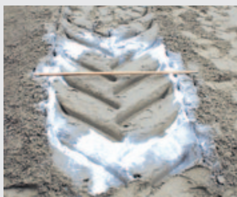
▲ Een soepele band heeft een grote footprint in de lengte en zo een laag gewicht per cm 2 .
