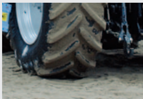
▲ De breedte over de nokken is bij veel banden minder dan de breedte in de aanduiding.
