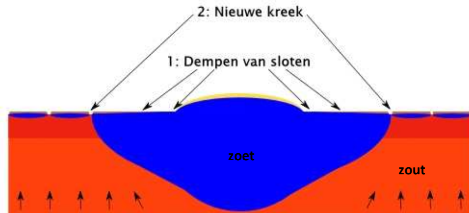
Figuur 4: Principe van 'De KREEK teRUG': Conceptueel beeld van de verdeling van zoet (blauw) en zout (rood) grondwater vóór en na het dempen van de sloten (1) en het graven van de nieuwe kreek (2).
