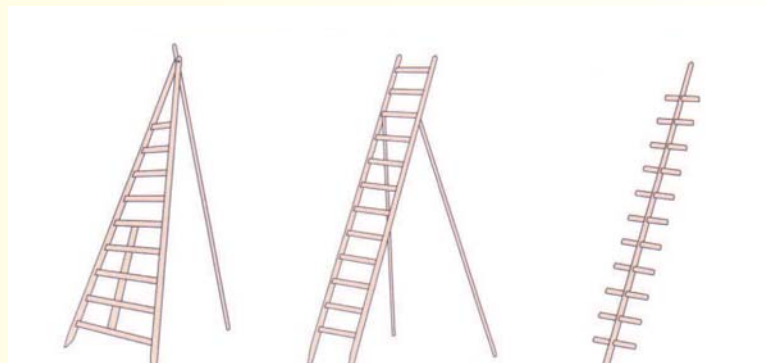
Van links naar rechts: tweebomige ladder met één steunboom; tweebomige ladder met twee steunbomen; éénbomige ladder.
