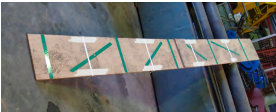
Figuur 10. Kalibratieplank t.b.v. cameraposities en opnamegebied per camera.
