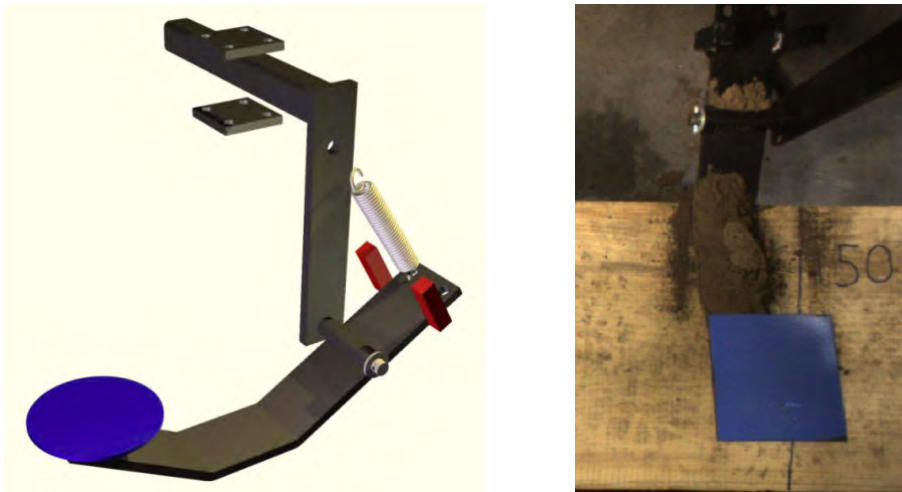
Figuur 12. Ontwerp kalibratiesleepvoet (links) en realisatie (rechts).
