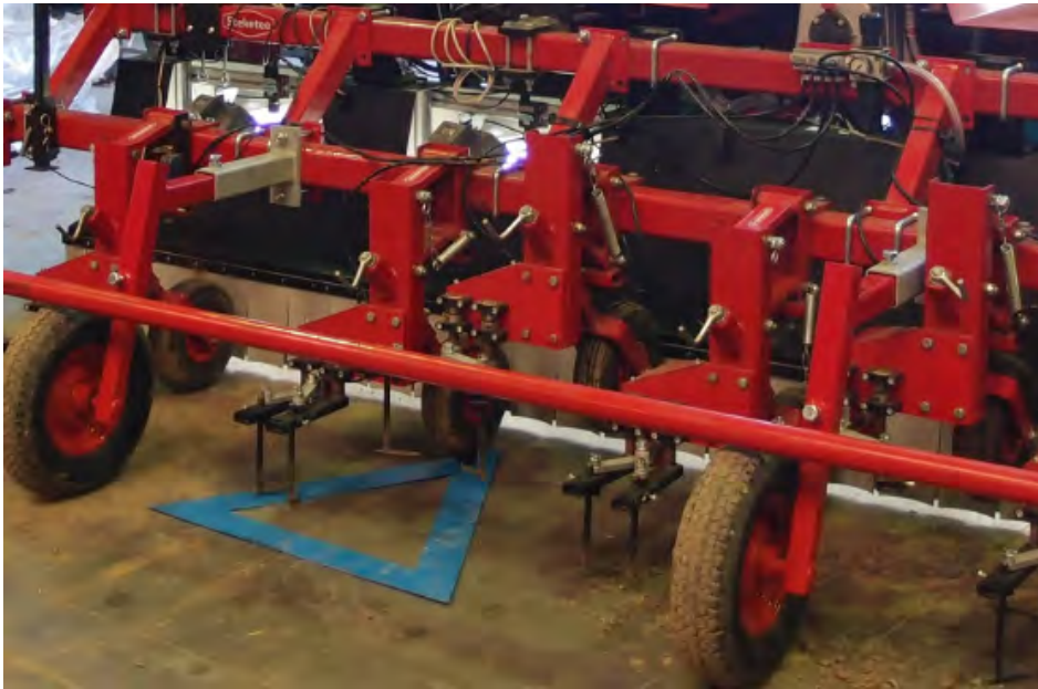
Figuur 6. Kalibratie driehoek voor het afregelen van de TRIG en DAD setting.
