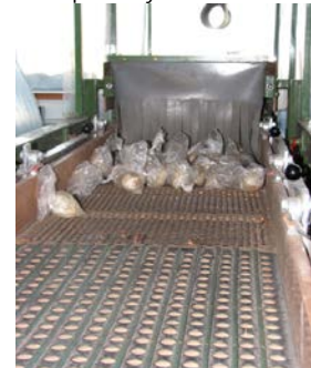
Fig. 1. Stresstoets op de sorteerband met in plastic verpakte hyacintenbollen
