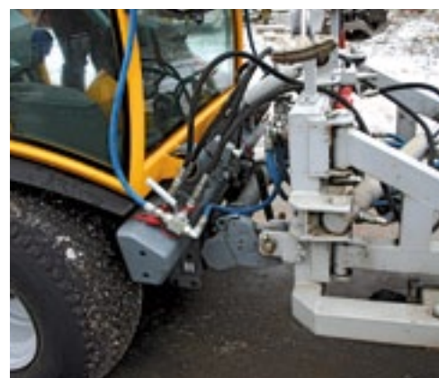
Het frontdek hangt in de driepuntheffinrichting van de Belos Trans Gigant.
