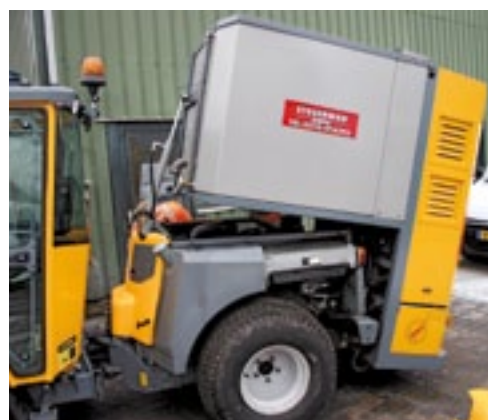
Voor onderhoud aan de motor, kiep je de hele unit achterover via een hydraulische handpomp.
