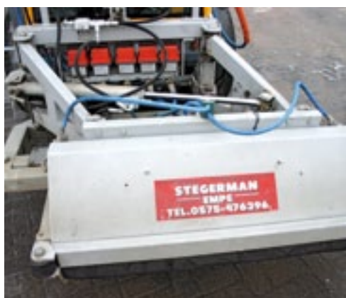
Het frontdek kan 25 cm naar links of rechts buiten de machine schuiven.
