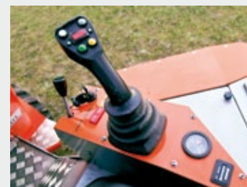
Met een joystick, rechts naast de bestuurder, bedien je de giek en de externe hydrauliek.
