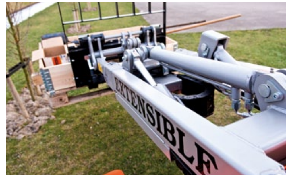
'Extensible' staat er op de giek van de Pixy 25. De giek kan namelijk 35 cm uitschuiven. Daardoor komt de arm tot een maximale hoogte van 2,70 meter.
