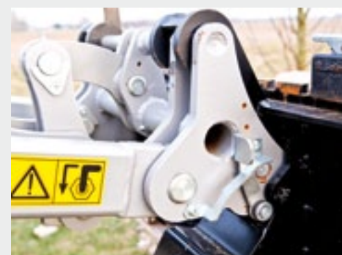
Z-kinematic zorgt ervoor dat de bak of palletvork in de hef altijd horizontaal blijft, ook als de arm geheven wordt.
