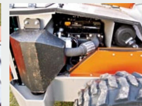
Het luchtfilter bevindt zich aan de rechterkant van de machine achter een scharnierende metalen kap.
