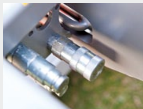
Aan de giek zijn twee hydraulische aansluitingen te vinden voor werktuigen, zoals een maaidek of een rolbezem.
