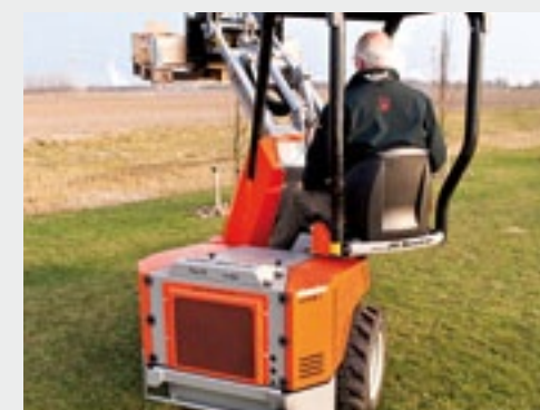
Het knikpunt bevindt zich weliswaar voor de bestuurder, maar het bestuurdersplatform is aan de voorwielen en de giek bevestigd.
