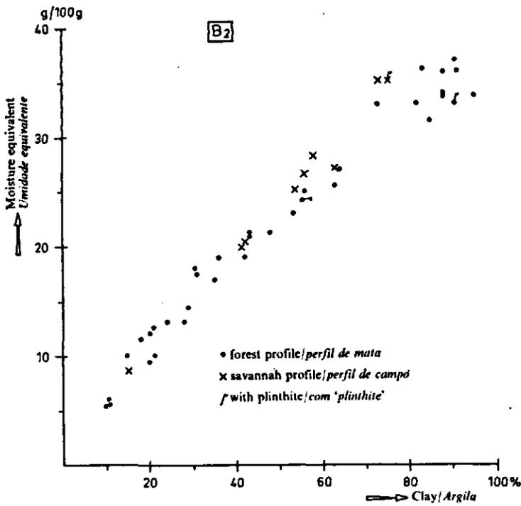
Fig. 35 Relação entre o equivalente de umidade e a percentagem de argila no horizonte B<sub>2</sub> de perfis de solos caoliniticos da Planície de drenagem livre
