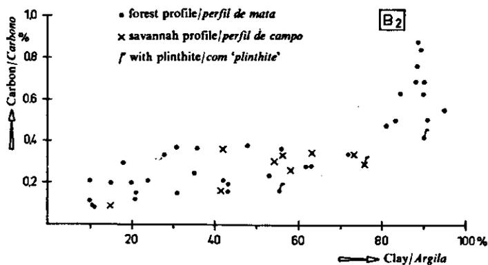
Fig. 29 Relação entre a percentagem de Carbono e a percentagem de argila no horizonte B<sub>2</sub> de perfis de solos caoliniticos da Planície de drenagem livre
