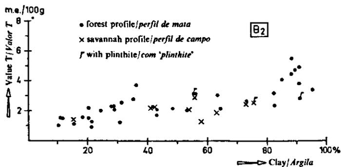
Fig. 31 Relação entre a percentagem de argila e o valor T nos horizontes B<sub>2</sub> de perfis de solos caolíniticos da Planície de drenagem livre
