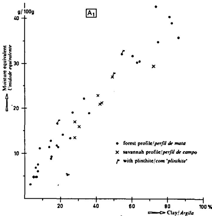
Fig. 36 Relação entre o equivalente de umidade e a percentagem de argila no horizonte A<sub>1</sub> de perfis de solos caoliniticos da Planície de drenagem livre
