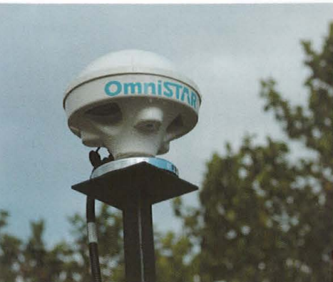
De topdresser weet waar hij is door middel van deze antenne.
