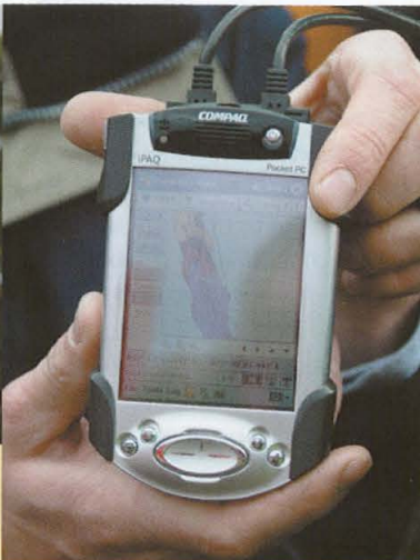
De topdresser wordt gestuurd door een PDA met een kaart van het terrein.
