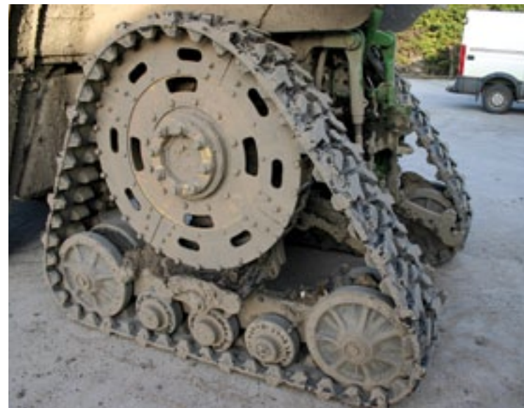
▲ Bert Hoff heeft rupsen met een breedte van 38 cm op een spoorbreedte van 1,50 meter.
