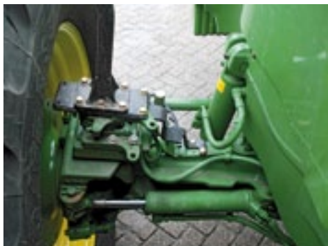
▲ Omdat beide fuseestukken een stuurcilinder hebben, is een stuurstang nodig.
