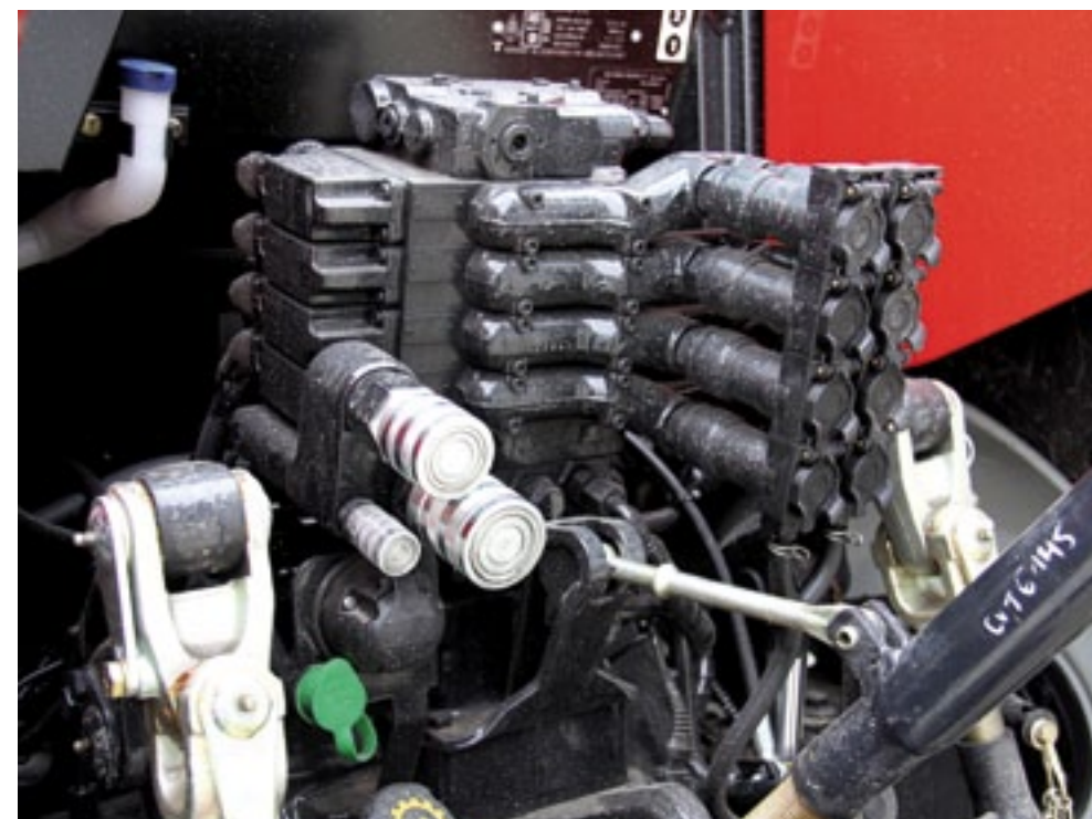
▲ Vier dubbelwerkende 'elektronische' ventielen zijn standaard. De derde is ook vanaf het achterspatbord te bedienen. De hoeveelheid olie die vanuit de achterbrug beschikbaar is voor de werktuigen, houdt met 20 liter niet over. De drie snelkoppelingen voor 'Power Beyond' zijn eveneens standaard.
