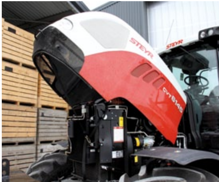
▲ De motorkap opent in zijn geheel (dat vraagt wat inspanning) en kan beduidend verder open dan hier getoond. Het koelpakket is dan goed bereikbaar en uitgeklaapt makkelijk te reinigen. De zescilinder is krachtig en zuinig.
