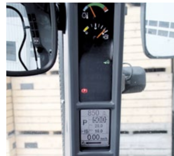
▲ De informatie in de A-stijl is matig zichtbaar.
