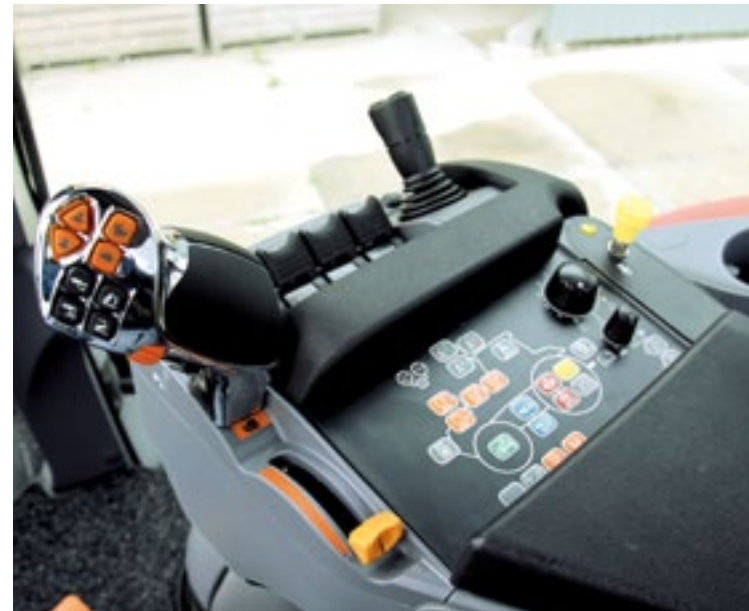
▲ De multifunctionele pook (links) bedient onder andere de cvt, voor-/achteruit, hef en hydrauliek. Alle functies doorgronden vraagt leertijd. De tiptoetsen (in het midden) zijn handig gekoppeld aan een tekening van de trekker.
