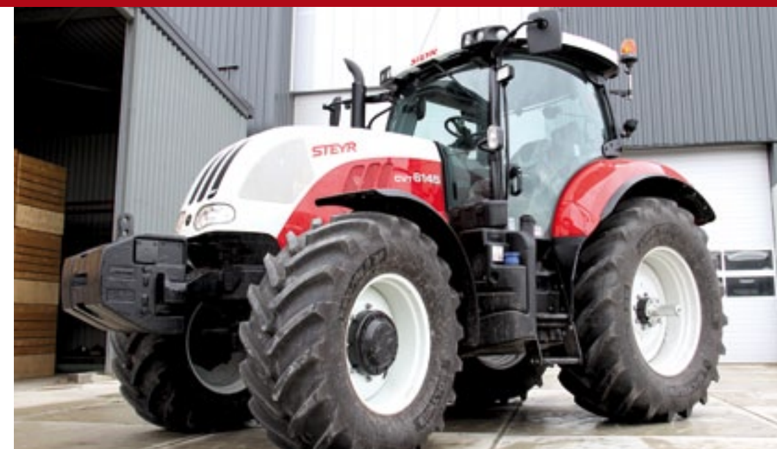
▲ De CVT is relatief kort en oogt daardoor hoog. 1.165 kg frontballast zit begrepen bij de standaardprijs.
