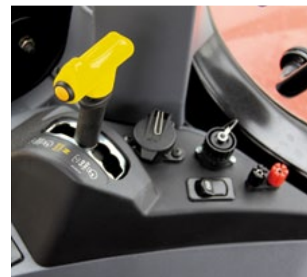
▲ De mechanische schakeling van 4 pto-toeren.
