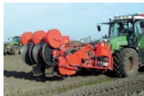
▲ Mechanisatiebedrijf Tol bouwde een frontrooier voor Dewulf.
