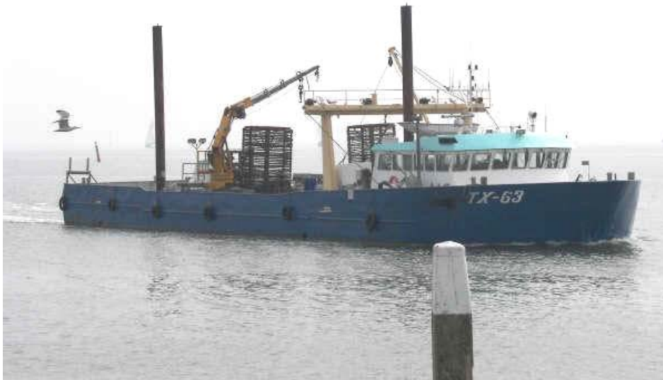
Figuur 6. TX63 tijdens een bemonstering van mosselzaadinstallaties, met spudpalen om het schip op één bepaalde locatie te kunnen verankeren. Deze techniek kan op het Marsdiep vanwege de diepte niet worden toegepast. Foto: André Meijboom.
