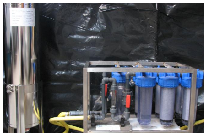
Voorfilter (aluminium huis) gekoppeld aan actief koolfilter
