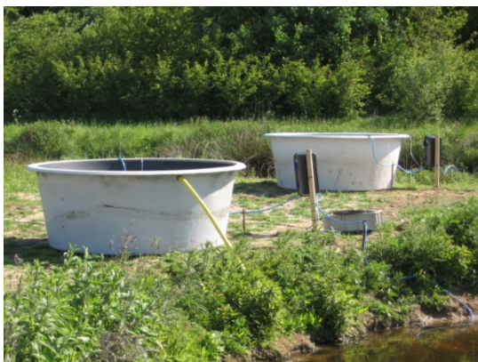
Figuur 4-2 Mesocosms opgesteld bij rwzi Land van Cuijk op posities 1 en 4.
