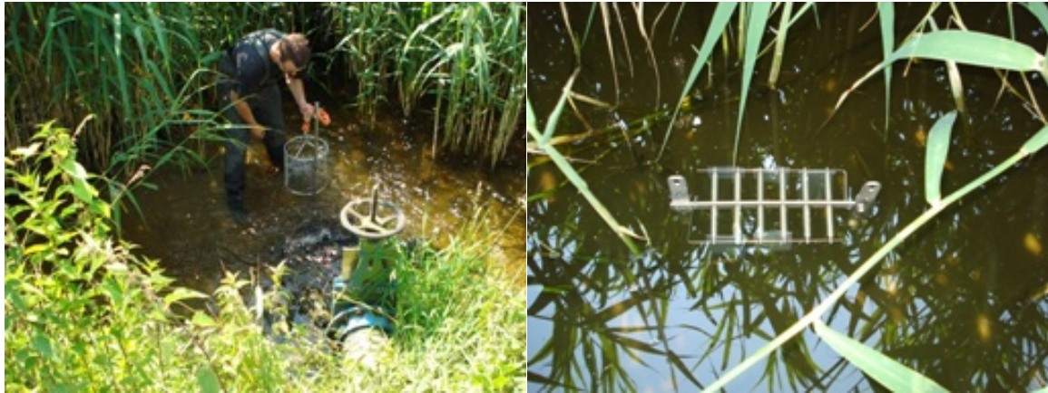
Figuur 1-4 Passive sampler in rietmoeras, op bodem geplaatst (rechts), of in frame opgehangen (links)
