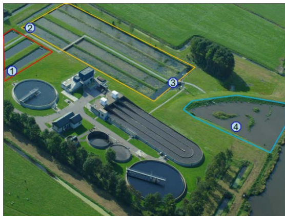
Figuur 1 Rwzi Grou met zuiveringsmoeras bestaande uit een bezinkvijver (Rood omkaderd), rietvelden (geel omkaderd) en lagune (blauw omkaderd). De nummers 1 tot en met 4 geven de bemonsteringsposities weer.
