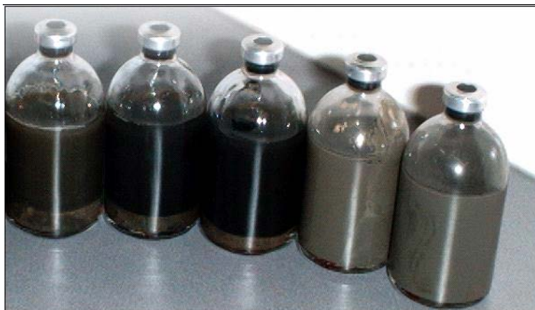
Figuur 10 Laboratorium experimenten laten zien dat micro-organismen in de sedimenten uit de zuiveringsmoerassen goed in staat zijn hormoon verstorende stoffen af te breken, mits voldoende zuurstof aanwezig is.
