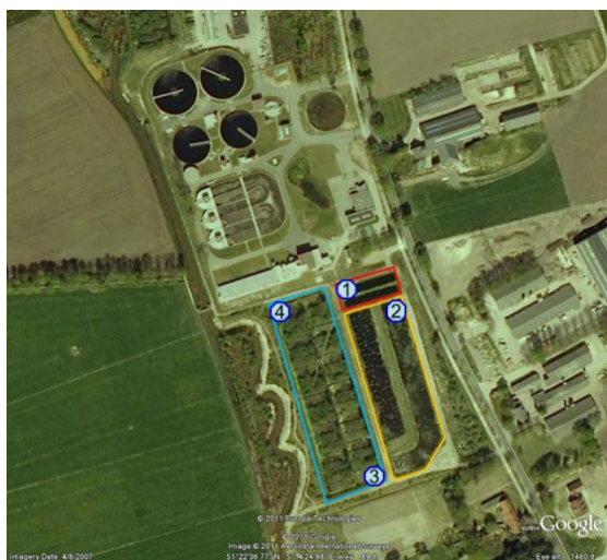
Figuur 2 Rwzi Hapert met zuiveringsmoeras bestaande uit een bezinkvijver (Rood omkaderd), rietvelden (geel omkaderd) en moerasbos (blauw omkaderd). De nummers 1 tot en met 4 geven de bemonsteringsposities weer.
