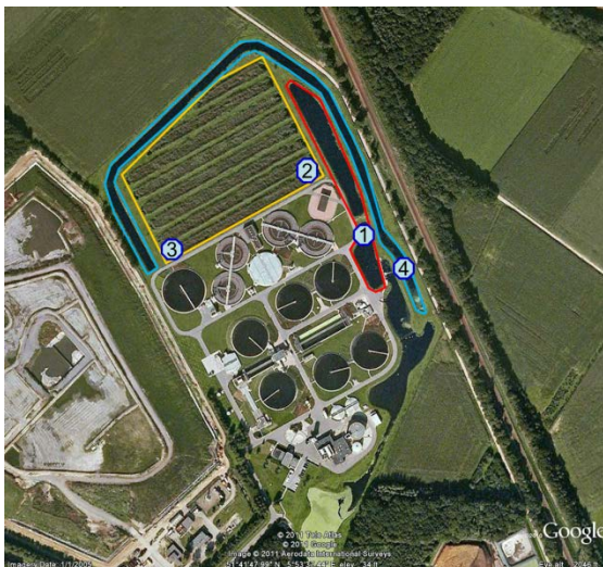
Figuur 3 Rwzi Land van Cuijk met zuiveringsmoeras bestaande uit een bezinkvijver (Rood omkaderd), rietvelden (geel omkaderd) en afvoersloot (blauw omkaderd). De nummers 1 tot en met 4 geven de bemonsteringsposities weer.
