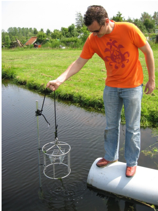
Figuur 5 Door het gebruik van passieve samplers van siliconen rubber kan een tijdgeïntegreerde waterbemonstering effectief worden uitgevoerd.
