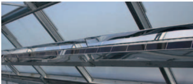
Figuur 17. Een prototype voor een CPV-module in de DaglichtKas.
