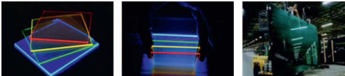
Figuur 18. Voorbeelden van glas uitgevoerd met coating (foto links en midden), waarbij het invangen van licht en de lichtgeleiding in het glas is verbeterd. Productie ook op grote oppervlakken mogelijk (foto rechts).
