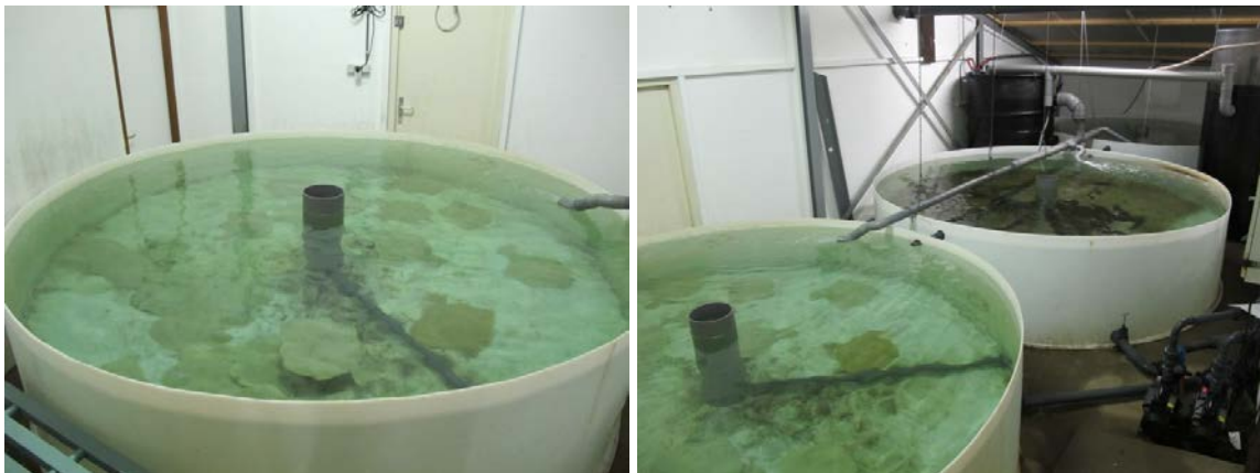
Figuur 11. Huisvesting van geselecteerde ouderdieren onder geconditioneerde omstandigheden, op basis van recirculatie met warmtepomp, eiwitafschuimer, ozon en moving-bed filter.
