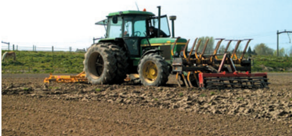
Het proefveldje zonder rijpaden werd bewerkt met een trekker op dubbele montering. De trekker bereed 80% van de bewerkte oppervlakte.
