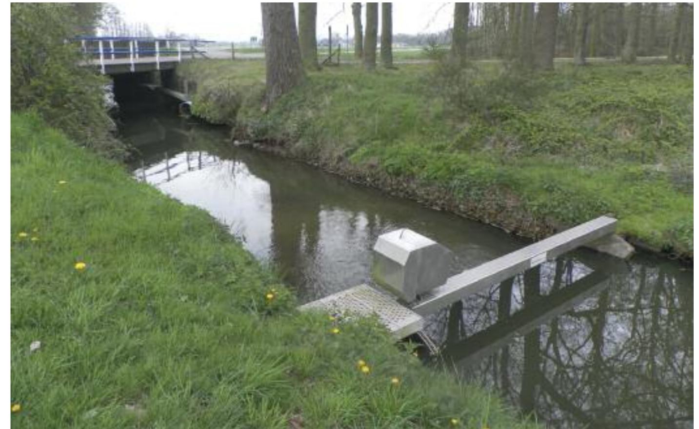
Debietproportionele meetlocatie in het stroomgebied Schuitenbeek, een locatie die in de zomer kan droogvallen (zie pagina 47)
