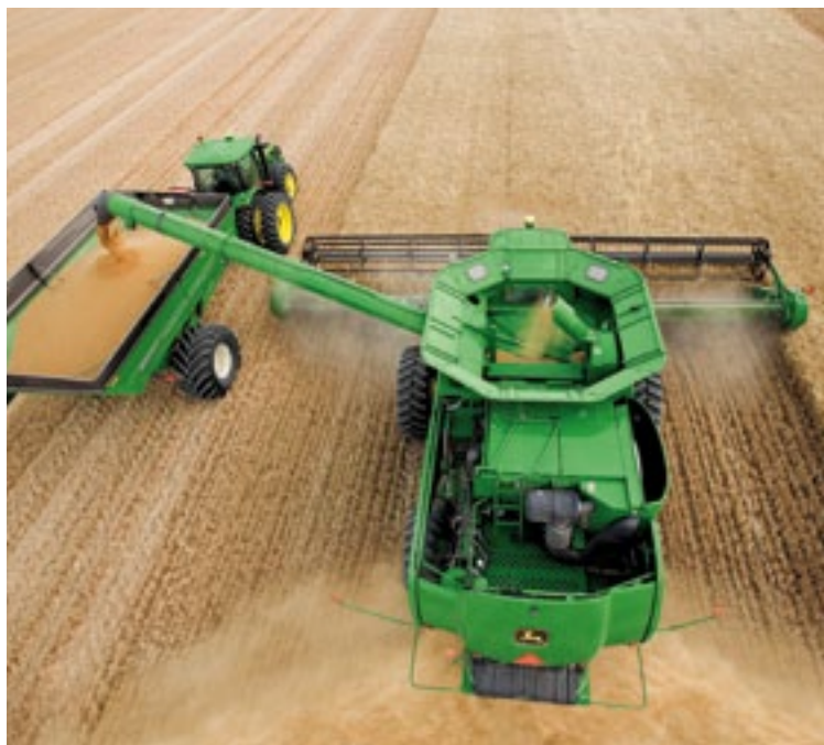
▲ Met Machine Sync van John Deere neemt de maaidorser de besturing van de naastrijdende overlaadwagen tijdelijk over.
