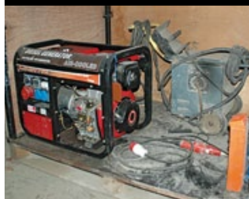
▲ Met de generator kun je in het veld laswerk verrichten, maar hij drijft ook de slijptol aan en levert stroom voor de magnetron.
