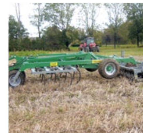
▲ Getrokken machines zijn vaak nauwkeuriger af te stellen dan gedragen exemplaren.
