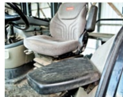
▲ De T190 kreeg als optie een gangbare bijrijdersstoel. In de hoek achter de bestuurder is er nog een te vinden.
