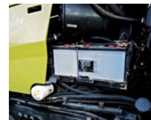
▲ De accu is achter de motor geplaatst. De warmte zorgt ervoor dat-ie het nogal eens begeeft.
