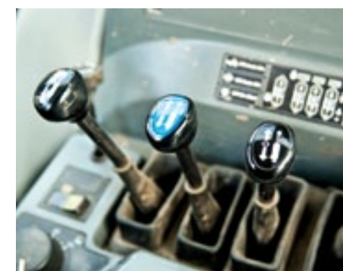
▲ De hydraulische ventielen worden mechanisch bediend met deze hendels rechts naast de bestuurder.
