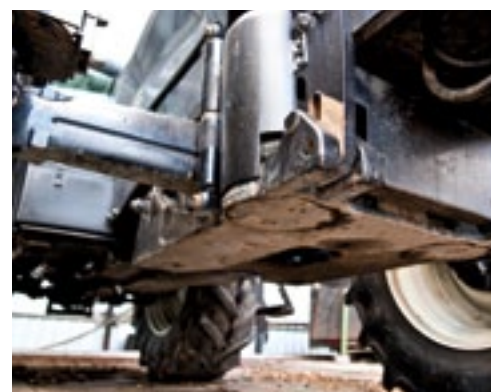
▲ De T190 is voorzien van een luchtgeveerde voorasvering. Daarvoor heeft de trekker dan ook een compressor aan boord.
