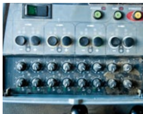
▲ De bediening van de elektronisch aangestuurde hydraulische ventielen komt wat ingewikkeld over.
