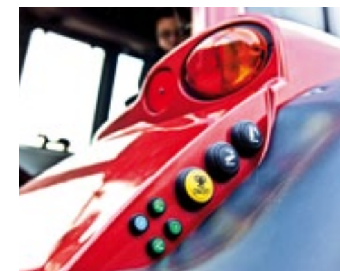
▲ Met knoppen op het spatbord bedien je hef, hydraulische ventielen en de aftakas.
