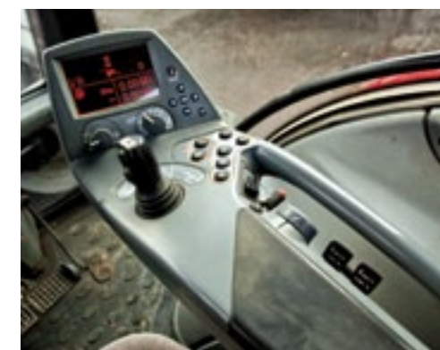
▲ De Advance armleuning. Met de joystick bedien je twee hydraulische ventielen. Een beeldscherm toont de trekkerinstellingen
