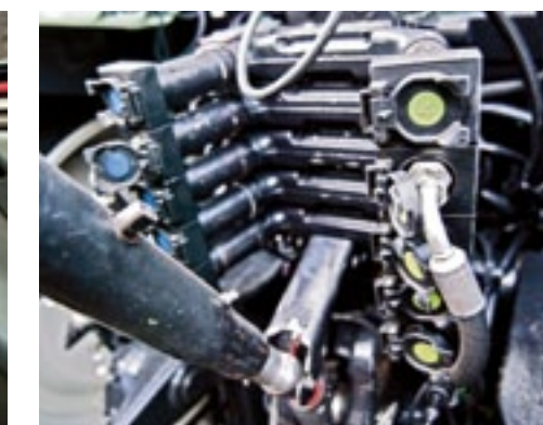
▲ De hydraulische ventielen zijn nu mooi geplaatst achterop de trekker. Jammer genoeg verschilt de kleuraanduiding niet per ventiel.
