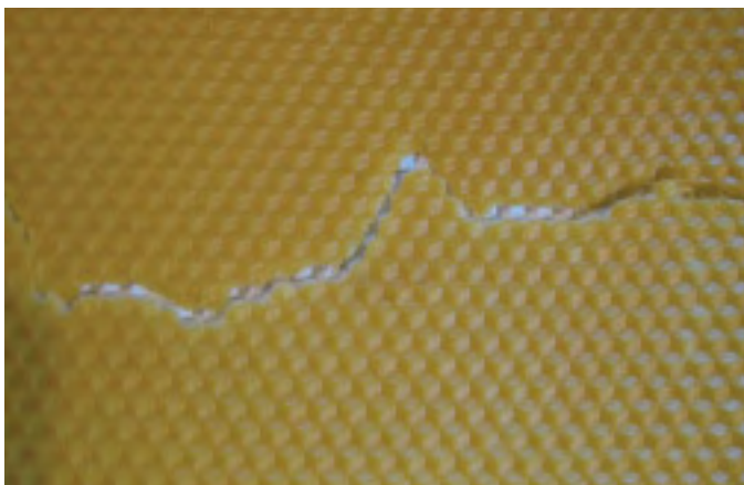
Een breuklijn door onevenwichtige wasopgieting.
