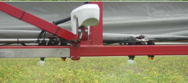
Plaatsspecifiek doseren loofdodingsmiddelen in aardappel. Prototype spuit met sensoren en doseringregeling per sectie van de spuitboom.
