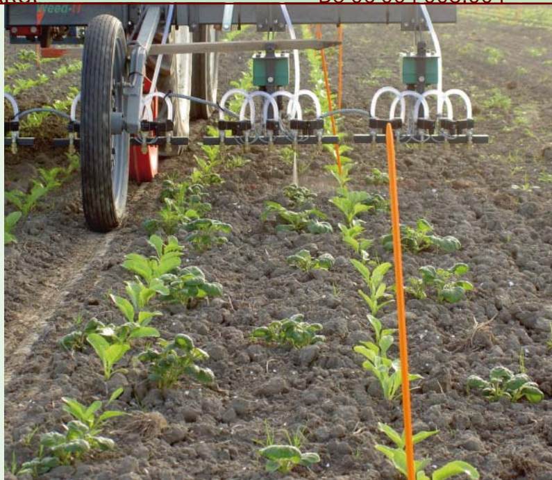
Met een sensor worden aardappelopslagplanten gedetecteerd en vervolgens op plantniveau bespoten met een landbouwversie van de Weed-it.
