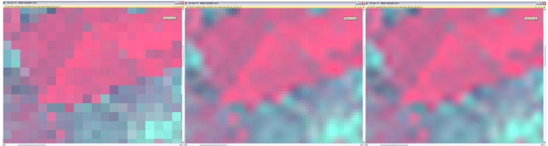
Figuur 6: a) Quickbird beeld op 30 m resolutie, b) resampling van 30 m naar 10 m, c) resampling van 10 m naar 2.8 m.
