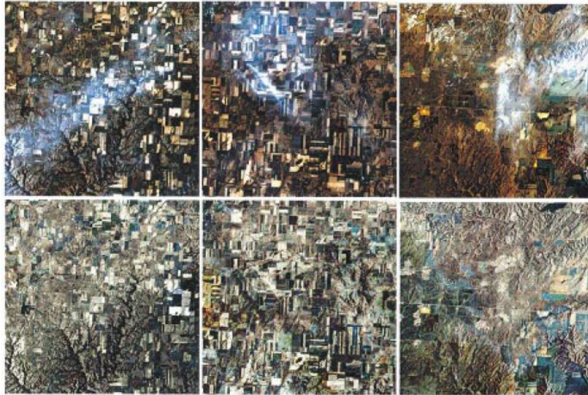
Figuur 7: Voorbeeld van Landsat beelden zonder (boven) en met atmosferische correctie (onder).
