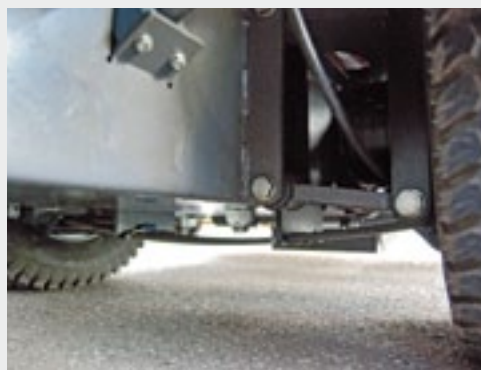
De vier aangedreven wielen van de VPM 3400 zijn onafhankelijk opgehangen.
