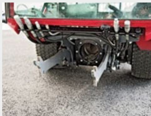
De hef van de VPM 3400. Daarboven de aansluitingen voor olie, hydrauliek en water.
