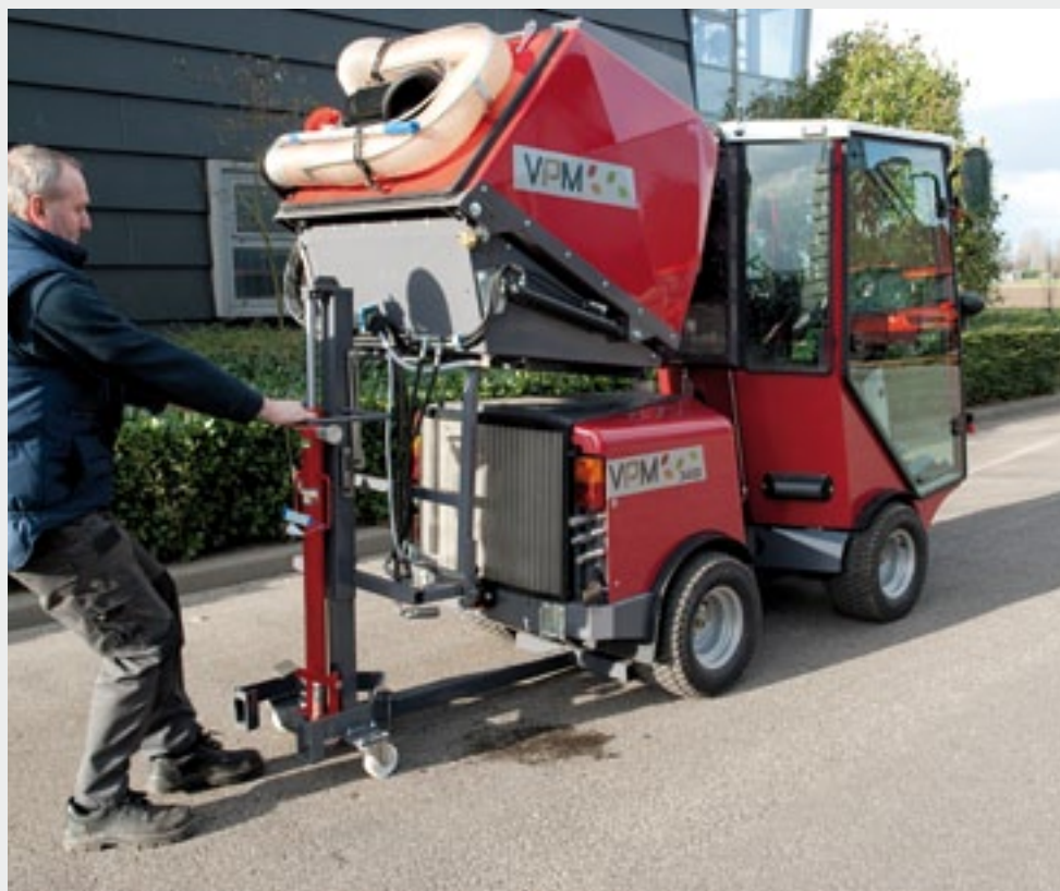
Met een frame met hydraulische cilinder kun je een opgebouwde bak afbouwen. Let ook op de grote radiator die de motor en de olie koelt.
