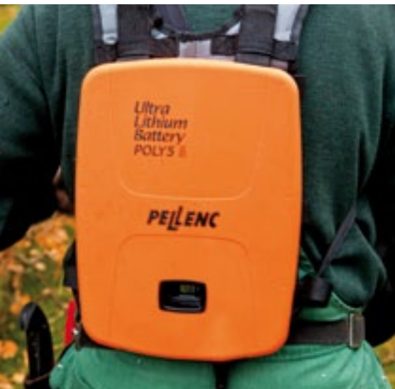
De accu van Pellenc hangt op de rug en weegt 3,7 kg. De ladingstoestand is digitaal af te lezen in het kleine display.
