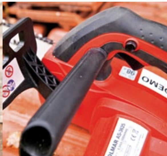
De Dolmar bedient net als de Stihl via het indrukken van een veiligheidsknop met de duim en het 'handgas' met de wijsvinger.
