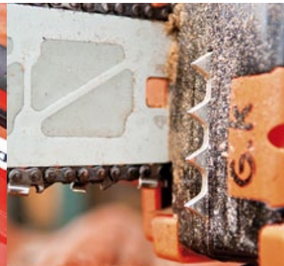
De Pellenc heeft een stoere metalen kam voor het 'afwikkeken' op takken. De 1/4 inch ketting heeft een snelheid van 14,4 m/s.
