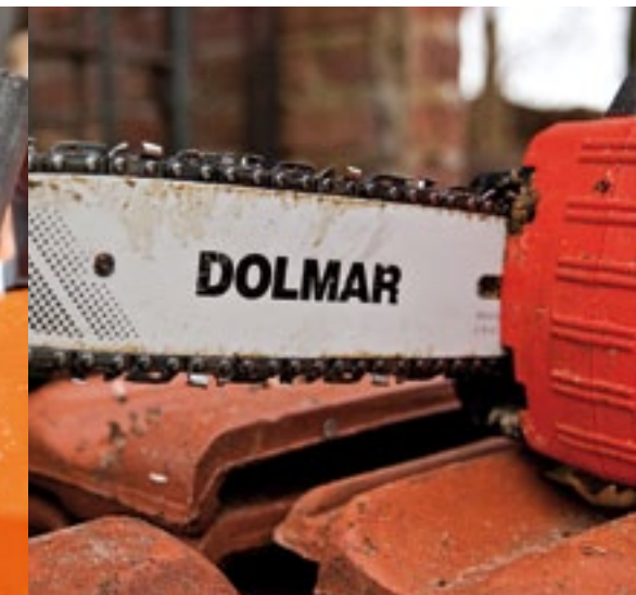
De Dolmar heeft als kam een aantal ribbels van kunststof. De 3/8 inch ketting lijkt voor een accuzaag aan de forse kant.
