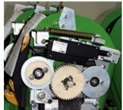
▲ De mechanische transmissie zonder beschermkap.
