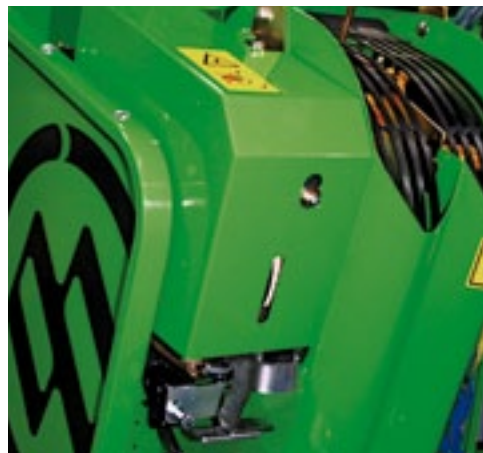
▲ De mechanische transmissie zit aan de zijkant van beide buitenste pootelementen.
