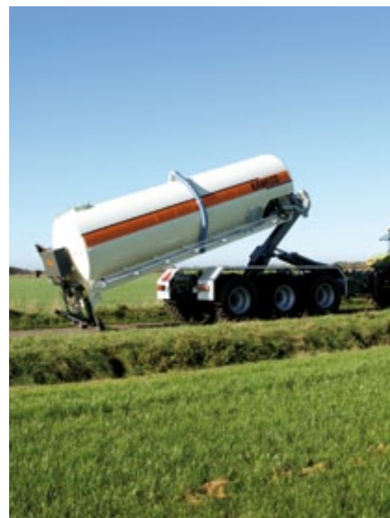
▲ Een ander voordeel van een haakarmsysteem: je kunt met een onderstel meerdere opbouwen gebruiken.
