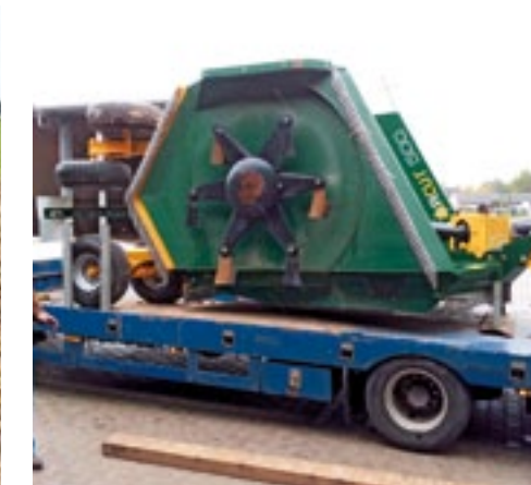
▲ Elke rotor van de Spearhead is uitgerust met zes dubbele messen.
