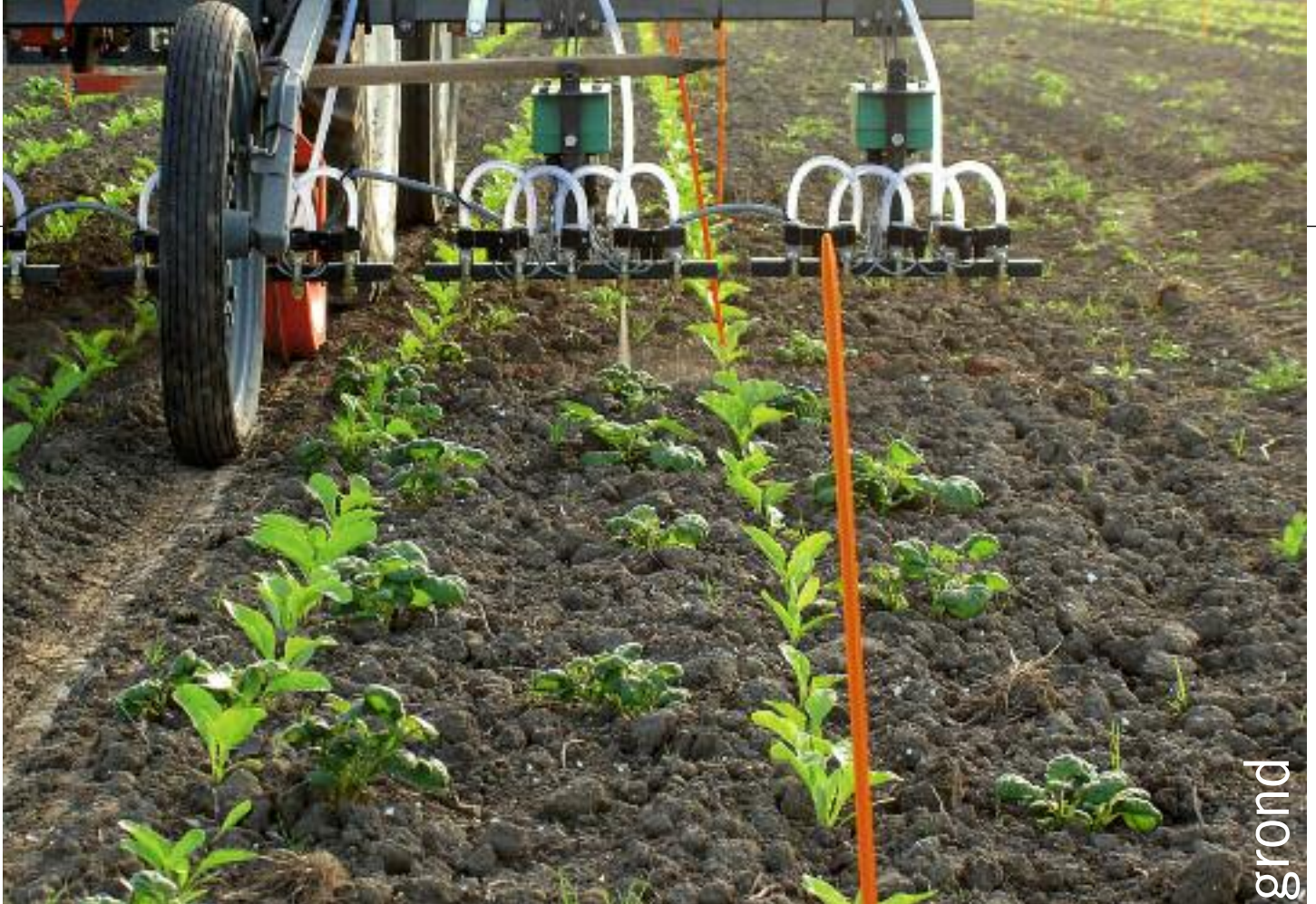
Sensorgestuurde plantgerichte bestrijding van aardappelopslag in de bietenteelt, hier met een prototype van Weed IT, draagt bij aan de vermindering van de milieubelasting.
