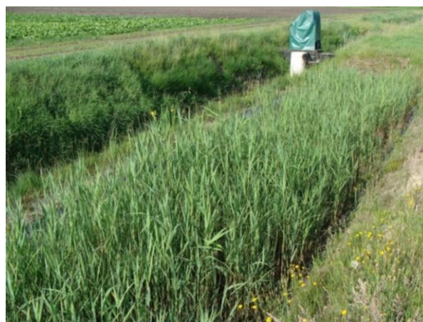
Beekbegeleidend vloeiveld voor nitraatverwijdering op PPO-proefbedrijf Vredepeel met links de sloot en achteraan één van de debietproportionele meetunits.
