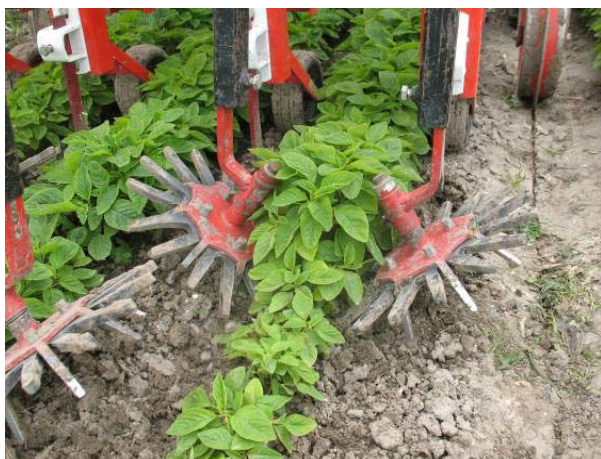
Foto 4. Schoffels gecombineerd met torsiewieders.
