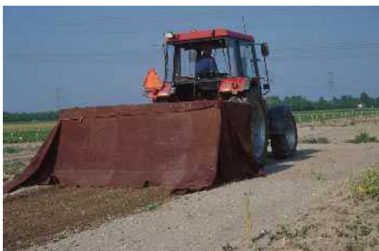
Foto 1. Afgedekte rotorkoepel voor de zaaibed bereiding na een vals zaaibed.
