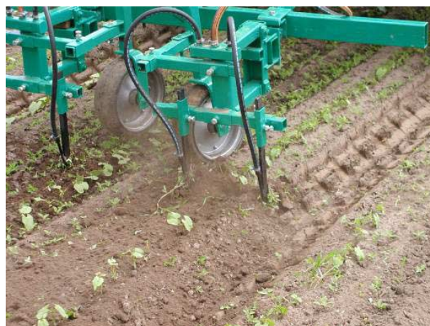
Foto 3. Schoffels gecombineerd met lucht (Pneumat).
