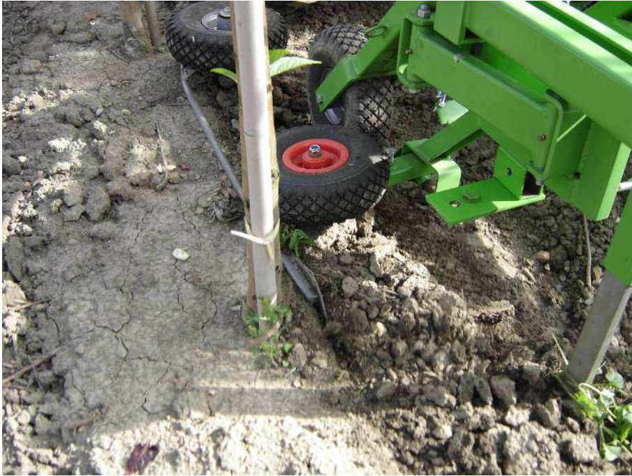
Mechanisch stuursysteem door middel van gewasgeleiding
