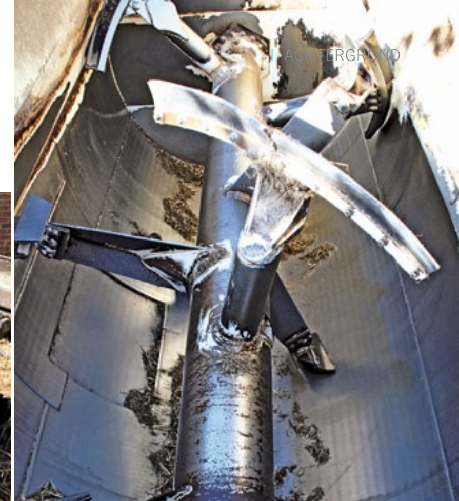
Sgariboldi maakt het verschil tussen peddels en schoepen duidelijk en is de enige die armen met peddels gebruikt.
