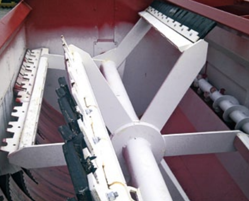
De haspel van Redrock lijkt in een aantal opzichten op die van Keenan, de details verschillen. Dat geldt voor meer onderdelen van beide wagens.
