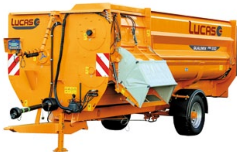
Lucas G. verdeelt de wagen in drie kamers en gebruikt de laadvijzel om te snijden met vaste messen. Lossen gebeurt ook met een vijzel.
